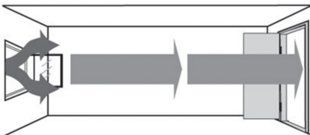
Příčné větrání: okno otevřeno, dveře nebo jiné okno v místnosti otevřeno. Plnohodnotná výměna vzduchu trvá cca 2-4 min. Ztráty na topení jsou minimální.
